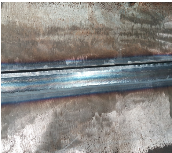
TF-210+TSW-12KH焊道外观
